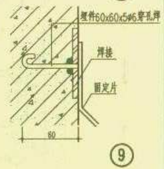
60系列平开门、连窗门安装节点图
